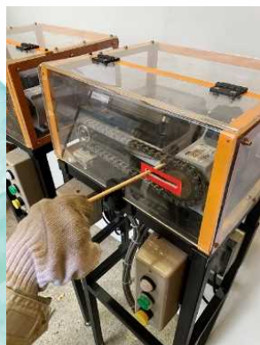
チェーン巻込まれ体感装置
