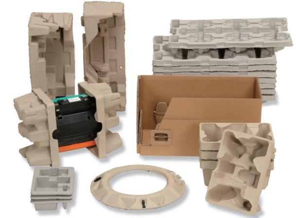
パルプモールド(ハイモール)は段ボールや新聞の古紙を主原料として製造する紙製の成型品です。高い成形精度とリブ構造により、化成品緩衝材に劣らないクッション性と耐荷重性があります。積み重ねも可能で、保管スペースの容積を小さくする事が出来るので積載効率が上がり物流や倉庫保管の経費削減に貢献します。
